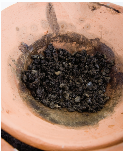
๓. ทำซ้ำ ๗-๘ ครั้ง จนผงเหล็กกรอบ
